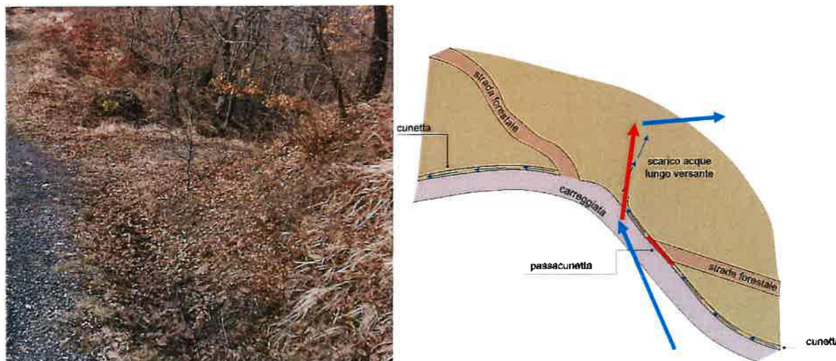
Figura 25-26 - Ubicazione e schematizzazione dell'intervento previsto
